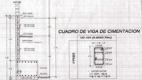
Detalle Zapata- Sobrecimiento ESC: 1/25
