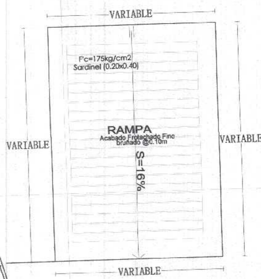
DETALLE DE RAMPA ESC. 1/125
