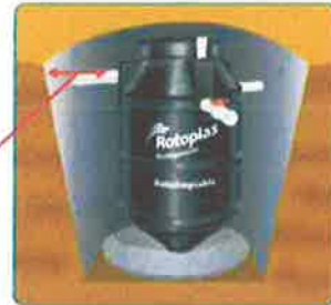
Rellenar con el material de la excavación y apisonar. (ver punto 6)
