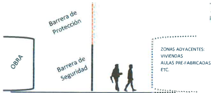
GRAFICO N° 01 VISTA PERFIL BARRERA DE PROTECCIÓN
