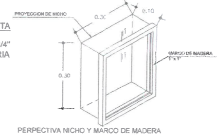
INSTALACION TIPICA DE NICHOS DE VALVULA COMPUERTA
