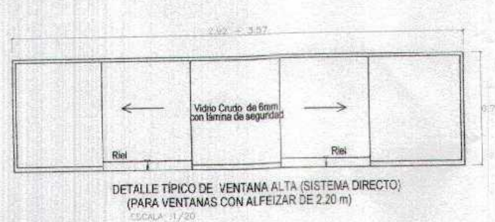
DETALLE TÍPICO DE VENTANA ALTA (SISTEMA DIRECTO) (PARA VENTANAS CON ALFEIZAR DE 2.25-2.35 m) ESCALA 1/20
