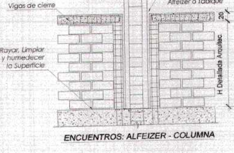
Utilizar en tabiques de Altura max. 3.30 m Espaciada a 3.00 m Max. Junta libre del tabique 2.5cm.
