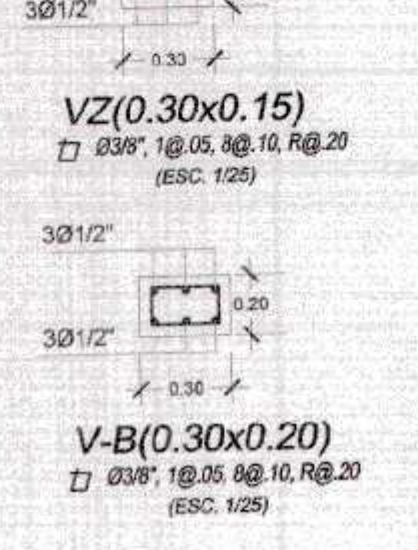
Utilizar en tabiques de Altura max. 3.30 m Espaciada a 3.00 m Max. Junta libre del tabique 2.5cm.
