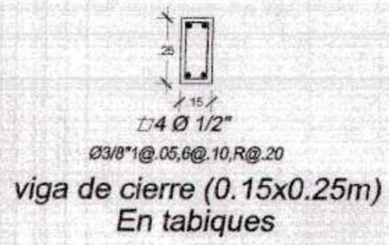
Utilizar en tabiques de: Altura max.: 3.30 m Espaciado a 3.00 m Max. Junta libre del tabique 2.5cm.
