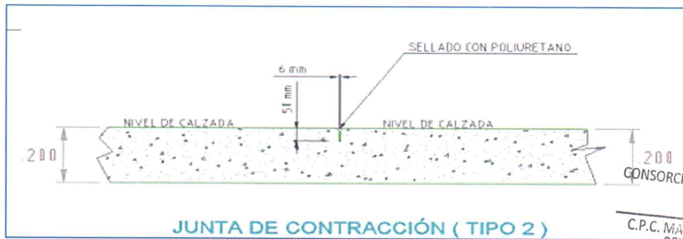
Figura 14-3: Juntas de contracción
