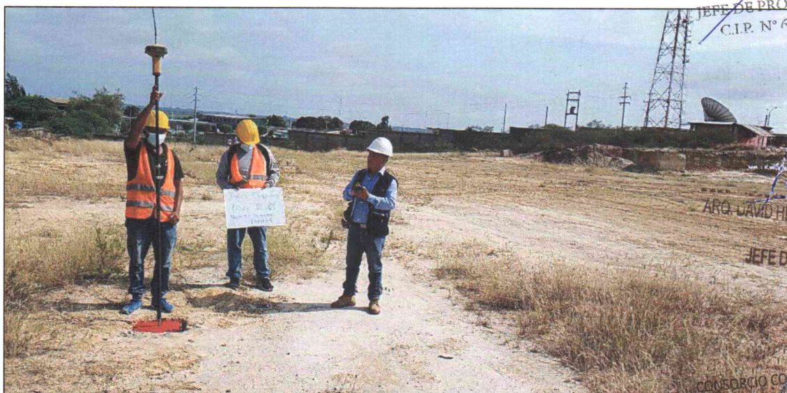
FOTOGRAFÍA N°04: Instalación del equipo GPS Diferencial para lecturas en el punto georreferenciado en la localidad anexo – Isco pampa
