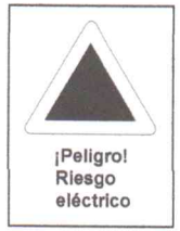
③ PLACA PARA PELIGRO RIESGO ELECTRICO
