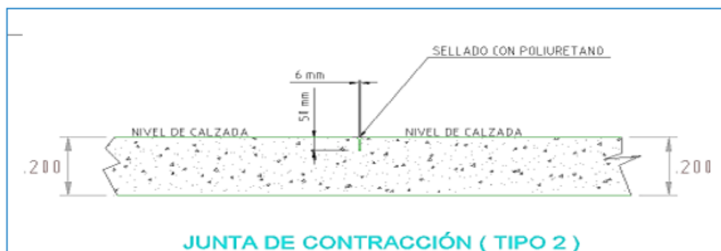
Figura 14-3: Juntas de contracción
