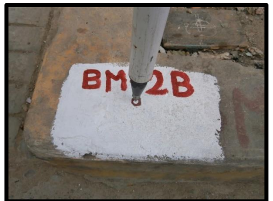
Fig. 11-16.- Monumentación de Estaciones y BM
