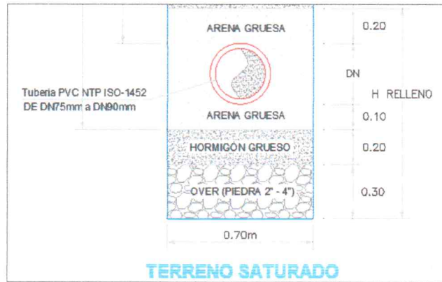
Figura 6. Cama de estabilización con material de préstamo (over).
