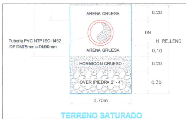
Figura 7. Cama de apoyo y encostillado, de material de préstamo (hormigón grueso).
