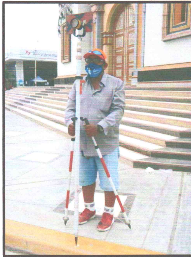
Fig. 6.- Bipode manteniendo la verticalidad del Prisma.
