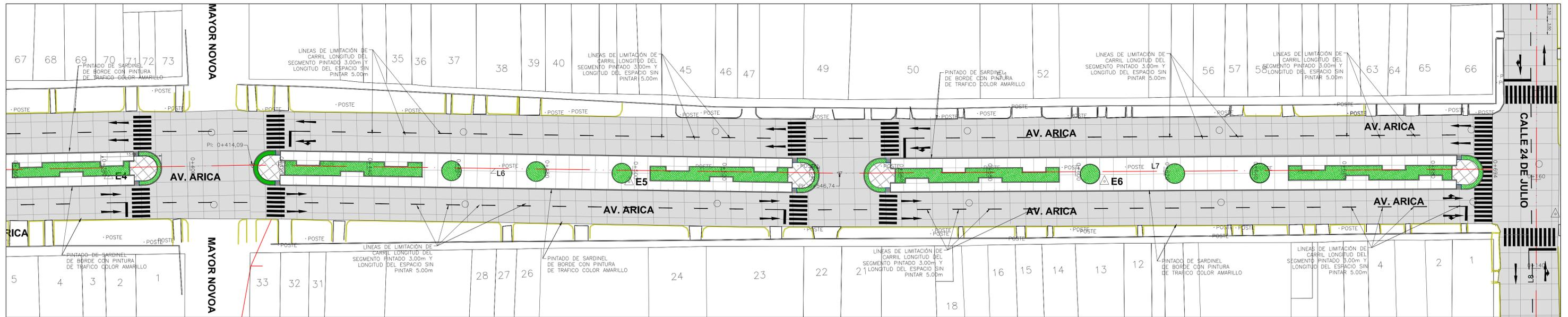
**PLANTA DE SEÑALIZACIÓN HORIZONTAL EN AV. ARICA Y PINTADO DE BORDE DE SARDINEL DE VEREDAS EXISTENTE DESDE PROG. 0+360.00 HASTA 0+694.00**
