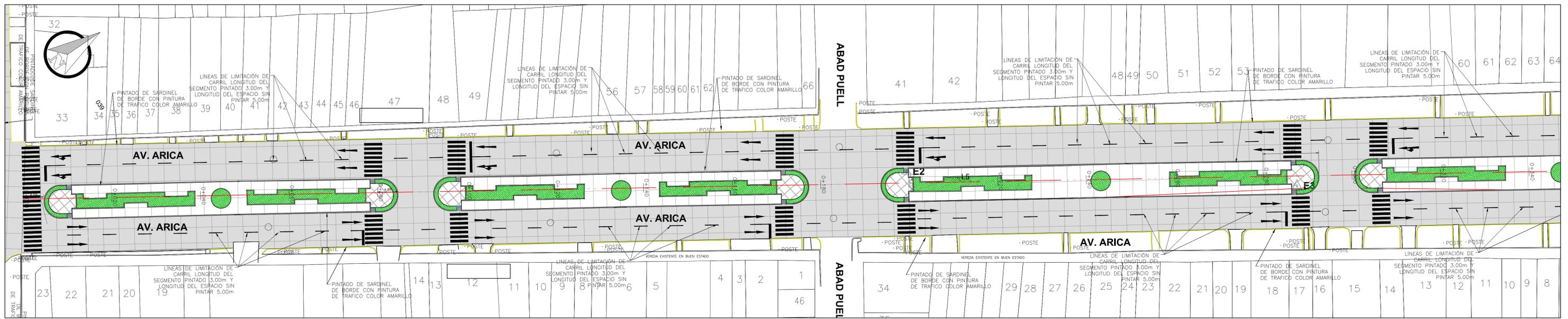
**PLANTA DE SEÑALIZACIÓN HORIZONTAL EN AV. ARICA Y PINTADO DE BORDE DE SARDINEL DE VEREDAS EXISTENTE DESDE PROG. 0+000.00 HASTA 0+340.00**
